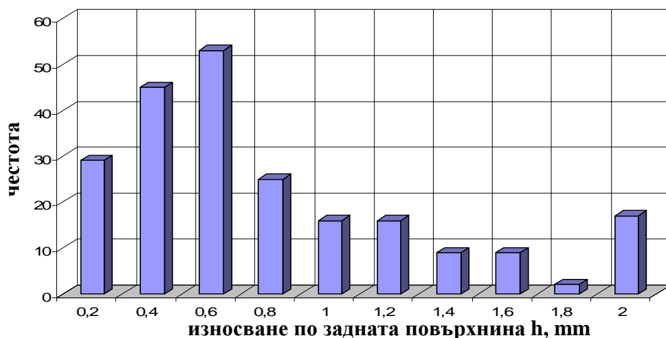
Фиг.2. Хистограма на износването на триъгълни режещи пластини TNMM160308 от марка M10
